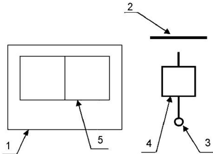
1 - оболочка; 2 - сборные шины, в т.ч. распределительные шины; 3 - зажимы для внешних проводников; 4 - функциональный блок; 5 - внутреннее изоляционное разгораживание
