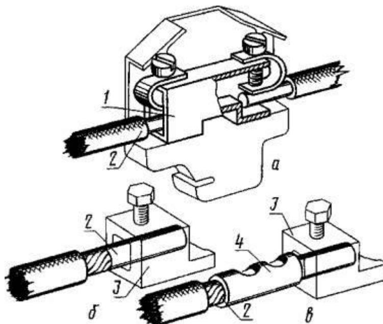
*a, б - однопроволочная (многопроволочная, сплавленная в монолит) жила; в - многопроволочная жила, оконцованный кабельным наконечником*
