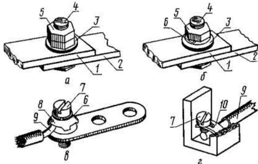
*a - с контргайкой; б - с пружинной шайбой; в - однопроволочная (многопроволочная) жила провода (кабеля) сеч. до 10 мм<sup>2</sup> с изгибанием в кольцо;*
