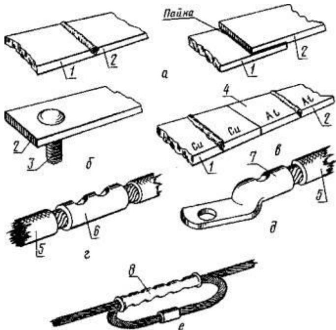
*a - сваркой или пайкой; б - со штыревым выводом сваркой; в - сваркой через переходную медно-алюминиевую пластину;*
