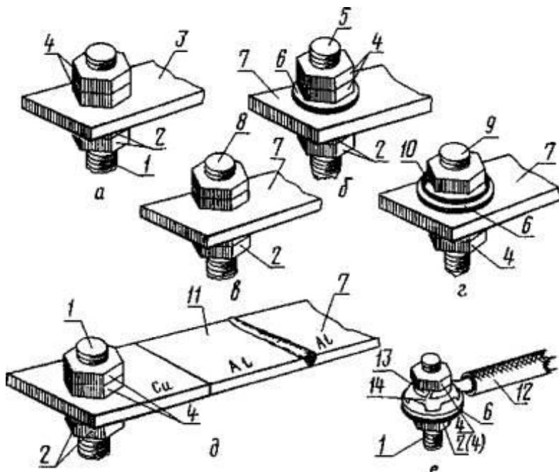
*a* - проводник из меди, твердого алюминиевого сплава или алюминия с защитным металлическим покрытием рабочей поверхности;
